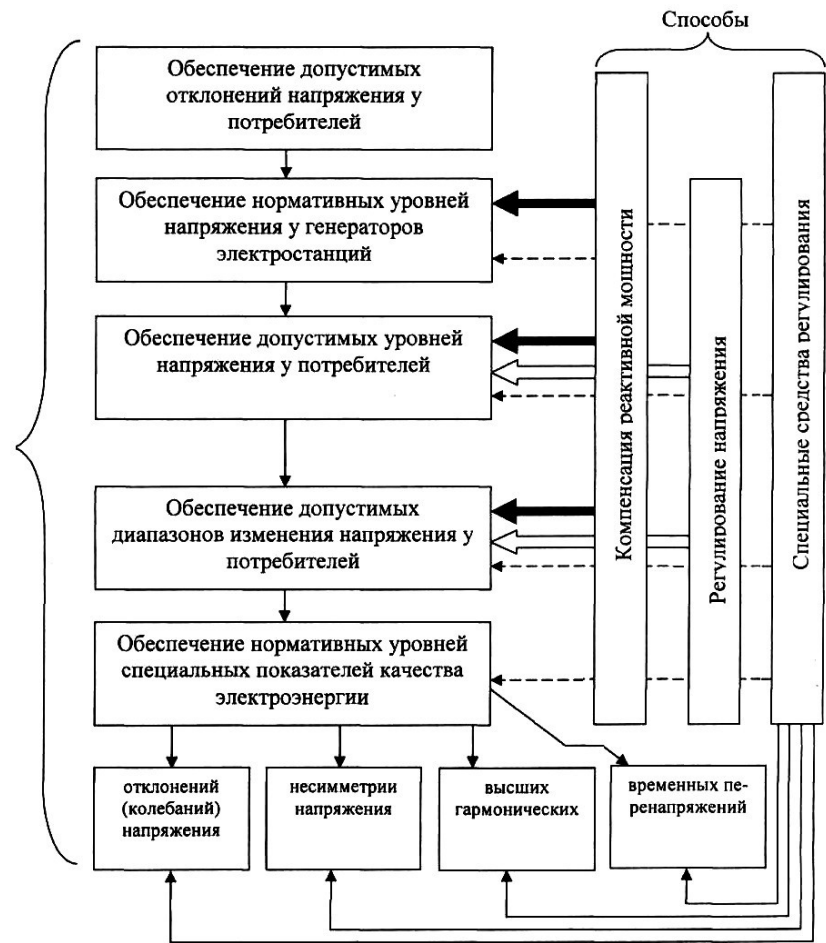
Рисунок 1 – Последовательность и способы решения проблемы повышения качества электрической энергии в электрической сети от 10 до 220 кВ
