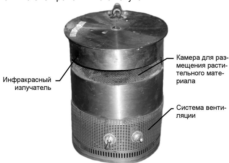
Рисунок – Прибор ИК-АЭРОФИТ
