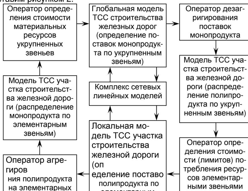
Рисунок 2 – Система моделей стратегического планирования и управления стоимостью транспортно-складских процессов на строительстве новой железной дороги
