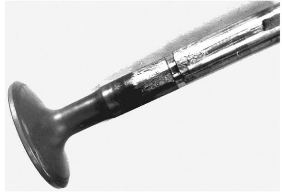
Рисунок 2 – Износ поверхности стержня выпускного клапана дизеля
