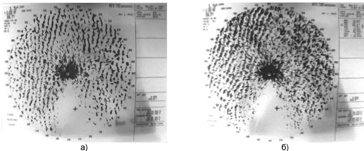
Рисунок 1 – Отображение (негатив) гребней волн на экране РЛС (Ориентация изображения – по северу,  $\kappa_s = 125^{\circ}$ ; теневой сектор РЛС 160°-210°)
