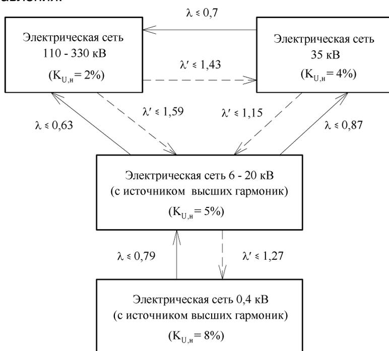
Рисунок 3 – Механизм распространения кондуктивной ЭМП  $\delta K_U$  в электроэнергетической системе
