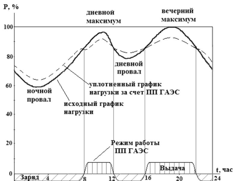
Рисунок 1 – Выравнивание суточного графика нагрузки энергосистемы за счет полупиковой (ПП) ГАЭС
