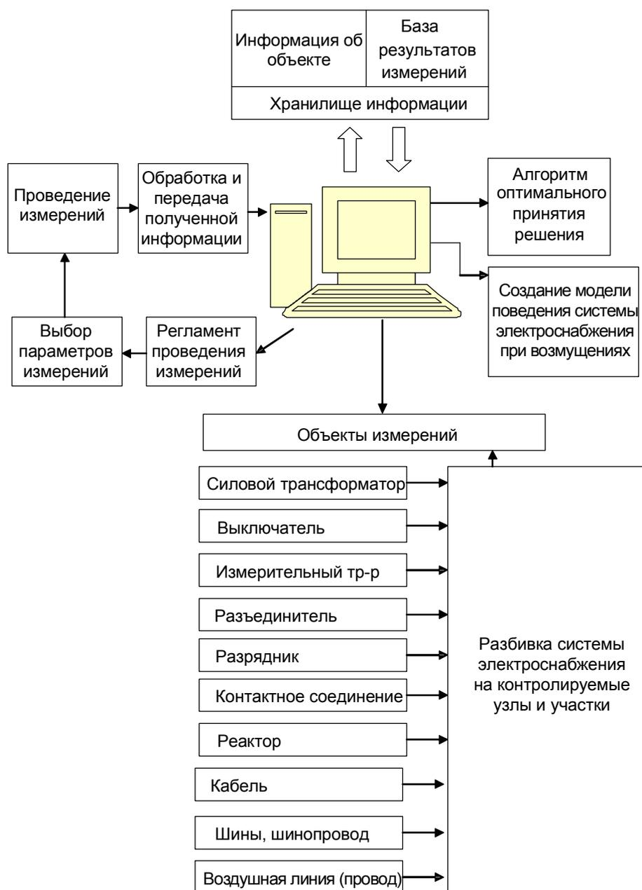
Рисунок 1 – Структурная схема программно-информационного измерительного комплекса
