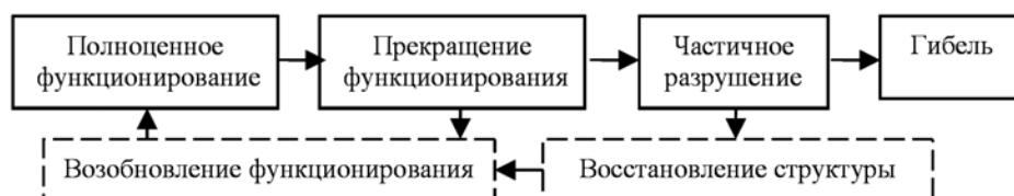
Рисунок 1 – Основные изменения в РО при электромагнитном повреждении
