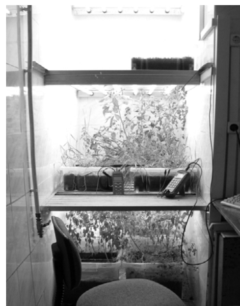
Рисунок 1 – Вегетационно-климатическая камера для исследования реакции растений, их активного повреждения под действием электрического тока и в комбинации с ультрафиолетовыми и инфракрасными потоками
