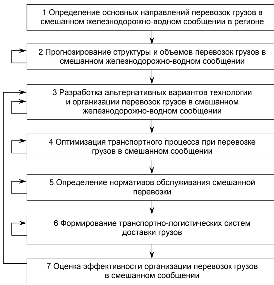
Рисунок 2 – Логическая последовательность решения задач обоснования, рациональной технологии и организации перевозок грузов в смешанном железнодорожно-водном сообщении
