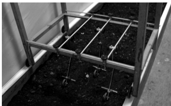
Рисунок 3 – Почвенный канал для исследования электродной системы электротехнологических установок
