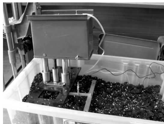
Рисунок 3 – Установка с электроприводом для исследования зоны взаимодействия электромагнитного поля электродной системы с почвой, растениями, воздушной средой и конструктивными элементами
