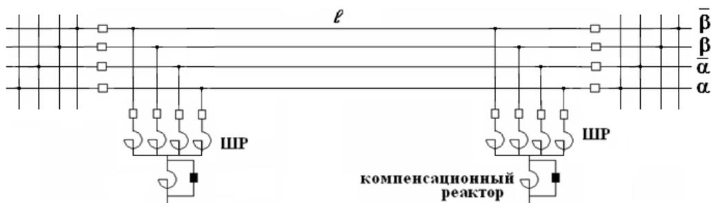
Рисунок 1 – Традиционная поперечная компенсация в четырёхфазной линии
