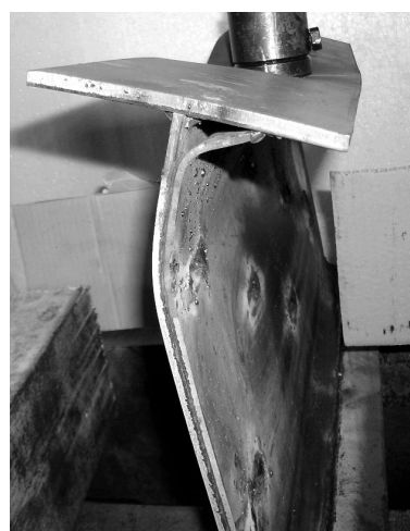
Рисунок 5 – Выпучина стенки образца с дублированной стенкой после прекращения нагружения (базовая стенка толщиной 5 мм; дублирующая 4 мм; вариант с отогнутыми под 45° краями у листового накладного элемента в месте крепления к поясам балки; усилие прикладывается в месте расположения двух электрозаклепок)
