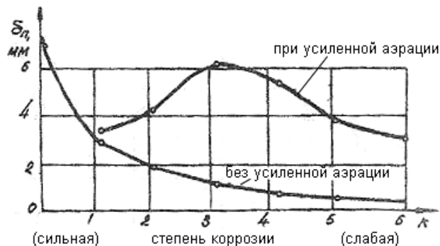
Рисунок 4 – Смещение максимума коррозии петли ( \delta_n ) анкерной плиты под действием усиленной аэрации
