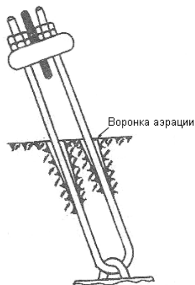
Рисунок 3 – Образование аэрации U-образного болта
