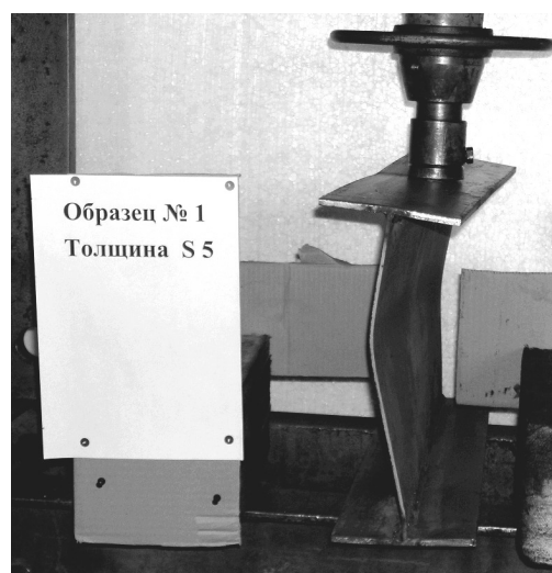
Рисунок 3 – Испытание образца с целостной стенкой толщиной 5 мм
