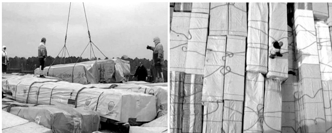
Рисунок 1 – Примеры неплотной укладки пакетов на палубе
