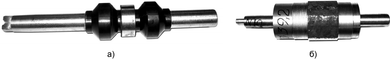
Рисунок 2 – Лабораторный образец: а)-резинометаллический палец; б)-резинометаллический шарнир в сборе
