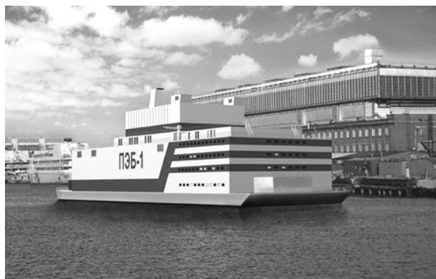
Рисунок 2 – Головной образец плавучей атомной станции, стоящей на якоре в ОАО ПО «Севмаш» (г. Северодвинск)
