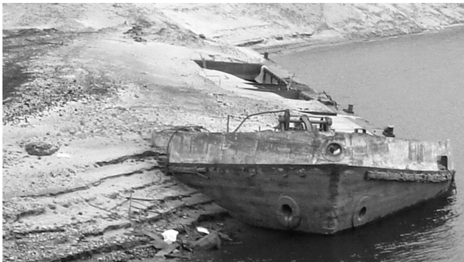
Рисунок 2 – Посадка корпуса лихтера на грунт ООО СК «Якутск»
