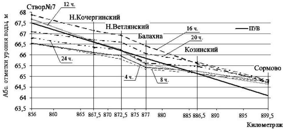
Рисунок 1 – Кривые свободной воды на участке Городец-Н. Новгород (2009 г., среднесуточный расход воды 1300 м³/с)
