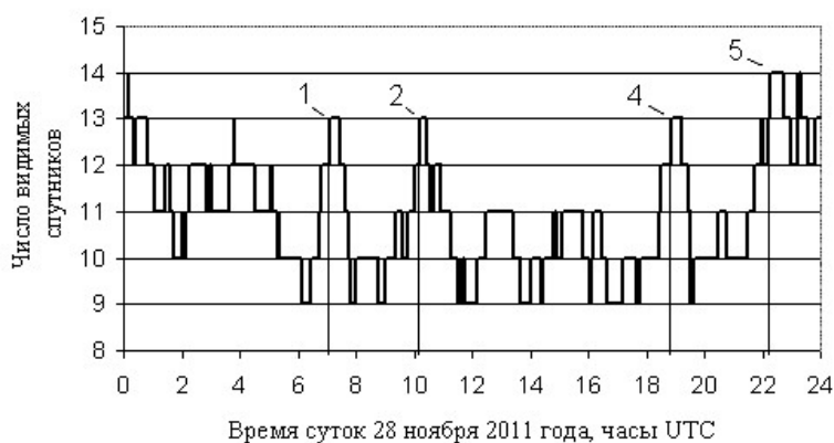
Рисунок 3 – Суточный ход числа одновременно видимых спутников системы GPS 28 ноября 2011 года
