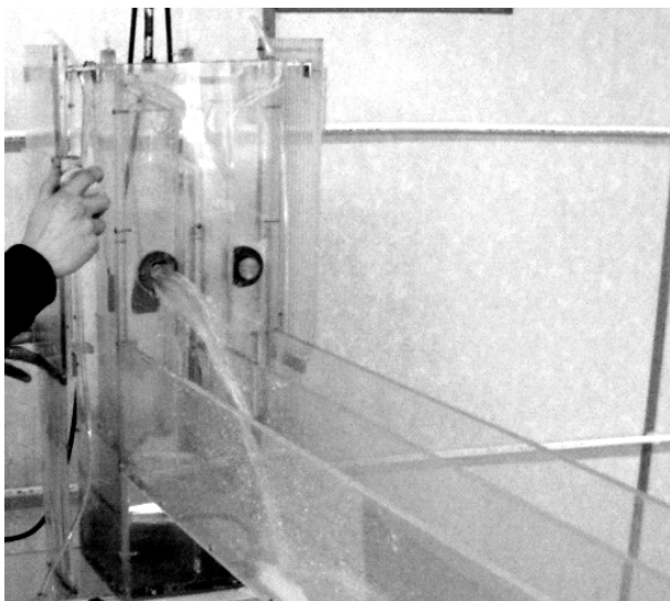
Рисунок 1 – Гидравлическая установка для испытаний истечения жидкости из малых отверстий
