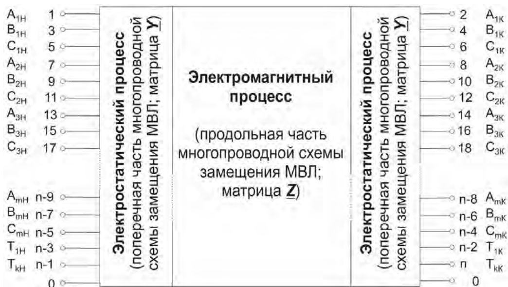
Рисунок 2 – Модель МВЛ в виде обобщенной многопроводной схемы замещения
