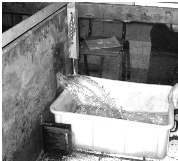
Рисунок 2 – Гидравлическая установка для испытаний истечения жидкости из больших отверстий
