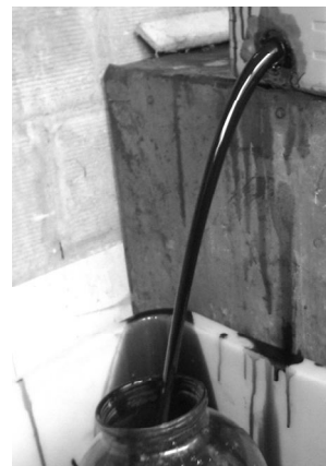
Рисунок 1 – Гидравлическая установка для испытаний истечения жидкости из отверстий
