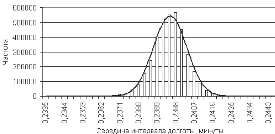
Рисунок 3 – Гистограмма распределения долготы в дифференциальном режиме работы приёмника GP-37
