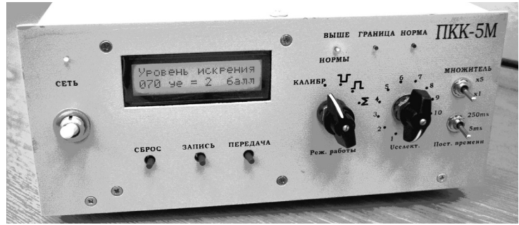
Рисунок 4 – Внешний вид доработанного прибора контроля качества коммутации ПКК-5М
