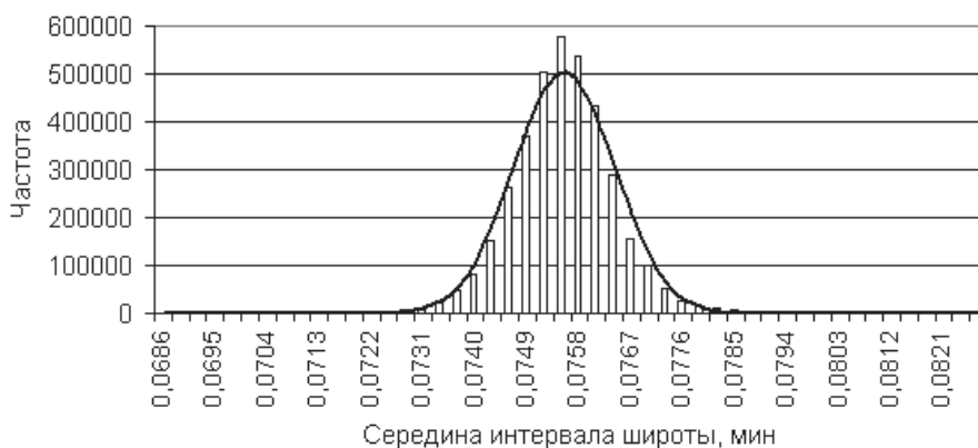
Рисунок 2 – Гистограмма распределения широты в дифференциальном режиме работы приёмника GP-37
