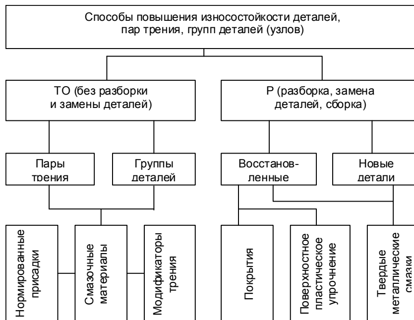
Рисунок 8 – Схема управления изнашиванием элементов машин
