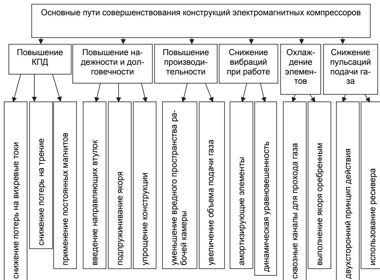
Рисунок 2 – Основные пути совершенствования конструкций электромагнитных компрессоров
