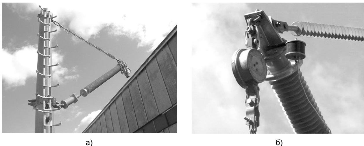
Рисунок 1 – Подготовленная к испытаниям траверса (а) и закрепленный измерительный пост (б)
