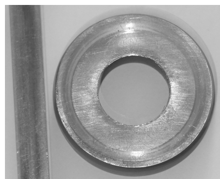
Рисунок 1 – Внешний вид поверхностей трения образцов возвратно-поступательного и торцевого трения при медьсодержащем смазочном материале
