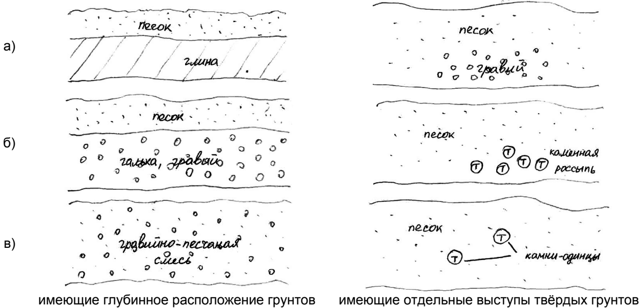
Рисунок 1 – Участки дна перекатов со сложными геологическими условиями
