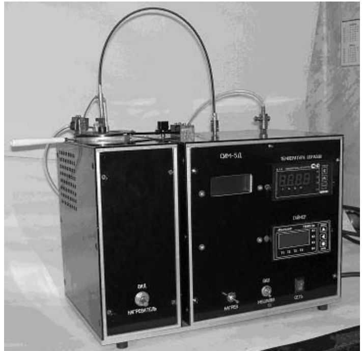
Рисунок 1 – Анализатор определения температуры вспышки нефтепродуктов СИМ-5
