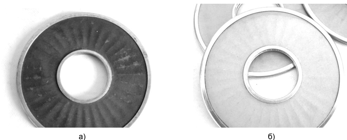
Рисунок 3 – Топливный фильтр до (а) и после (б) очистки
