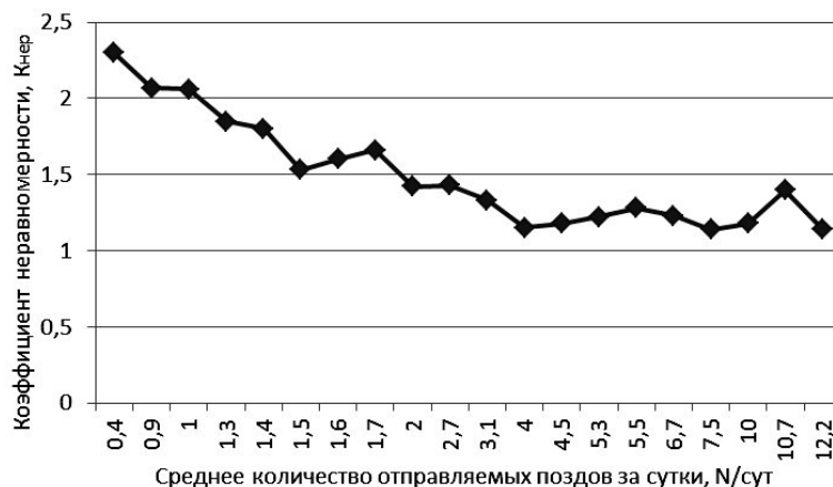
Рисунок 3 – Изменение коэффициента неравномерности в зависимости от мощности назначения
