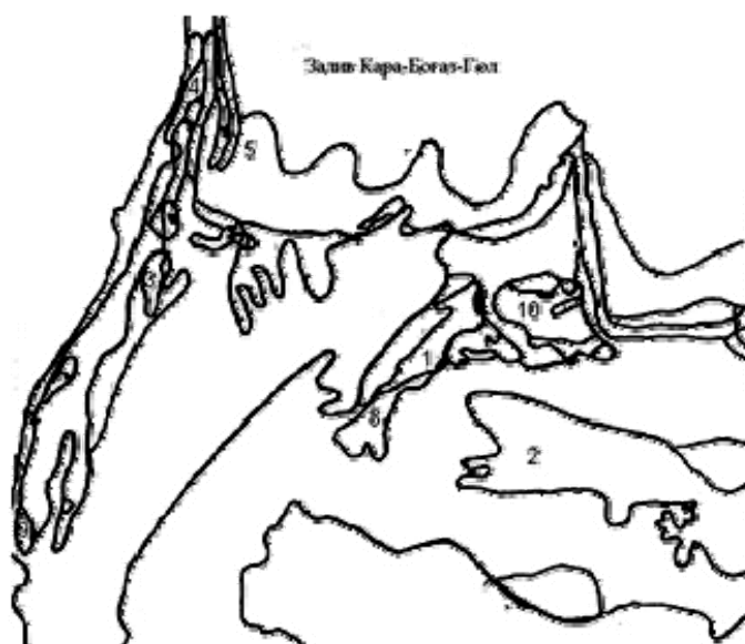
Рисунок – Фрагмент карты обобщенной грунтово-климатической характеристики района залива Кара-Богаз-Гол, Туркменистан. Масштаб 1:600 000: цифрами обозначены уровни изменения обобщенной грунтово-климатической характеристики районов
