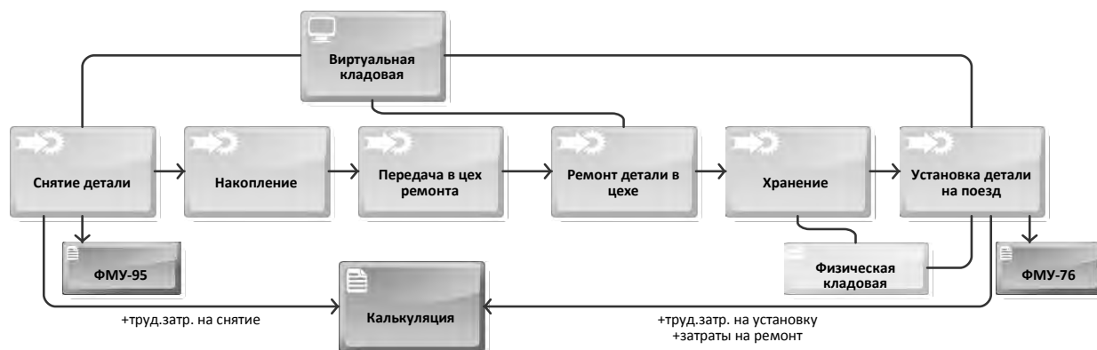
Рисунок 2 – Учет движения деталей и материалов, ремонтируемых непосредственно в депо, с отображением в виртуальной кладовой
