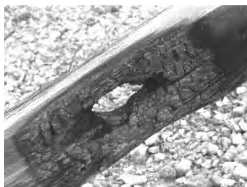
Рисунок 2 – Возгорание деревянных траверс и опор из-за токов утечки
