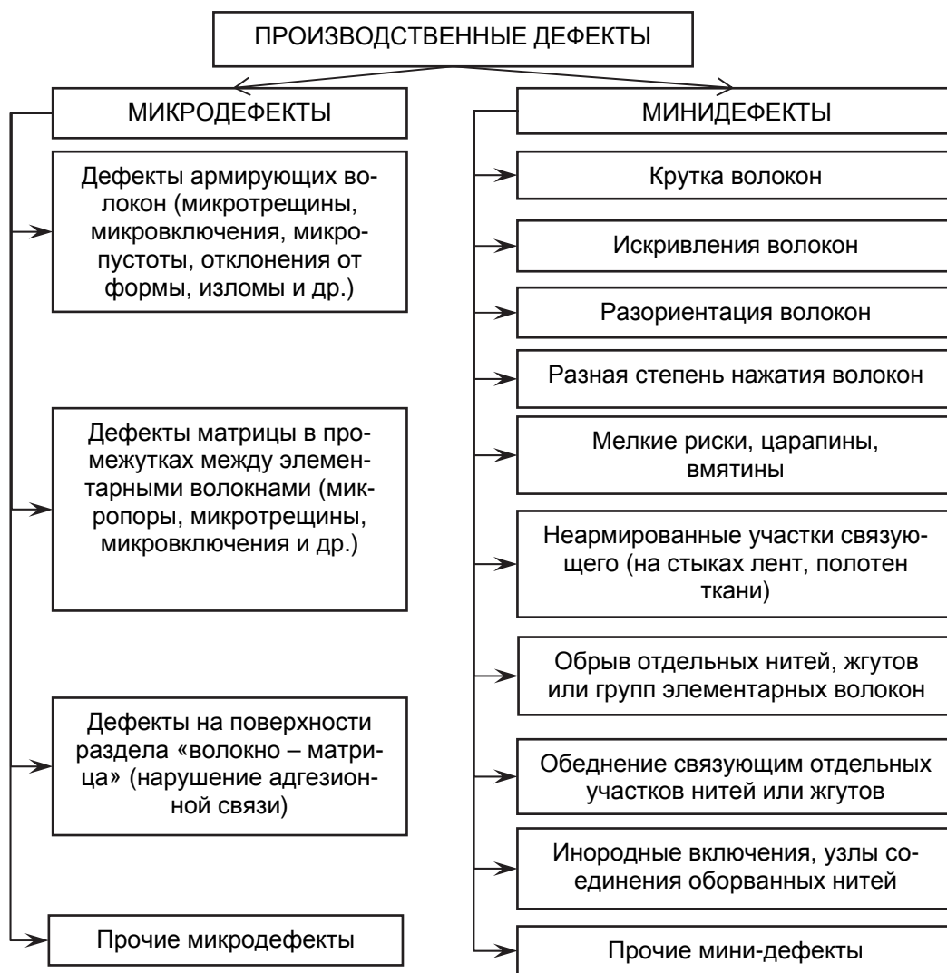
Рисунок 5 – Классификационная схема технологических мини- и микродефектов в конструкциях из композитов
