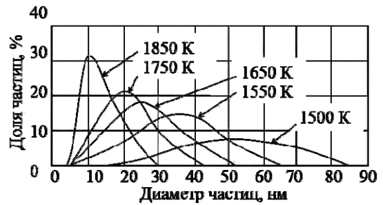
Рисунок 2 – Кривые распределения диаметров нанодисперсных углеродных частиц, полученных при пиролизе жидких углеводородов: по результатам электронно-микроскопических измерений [7]
