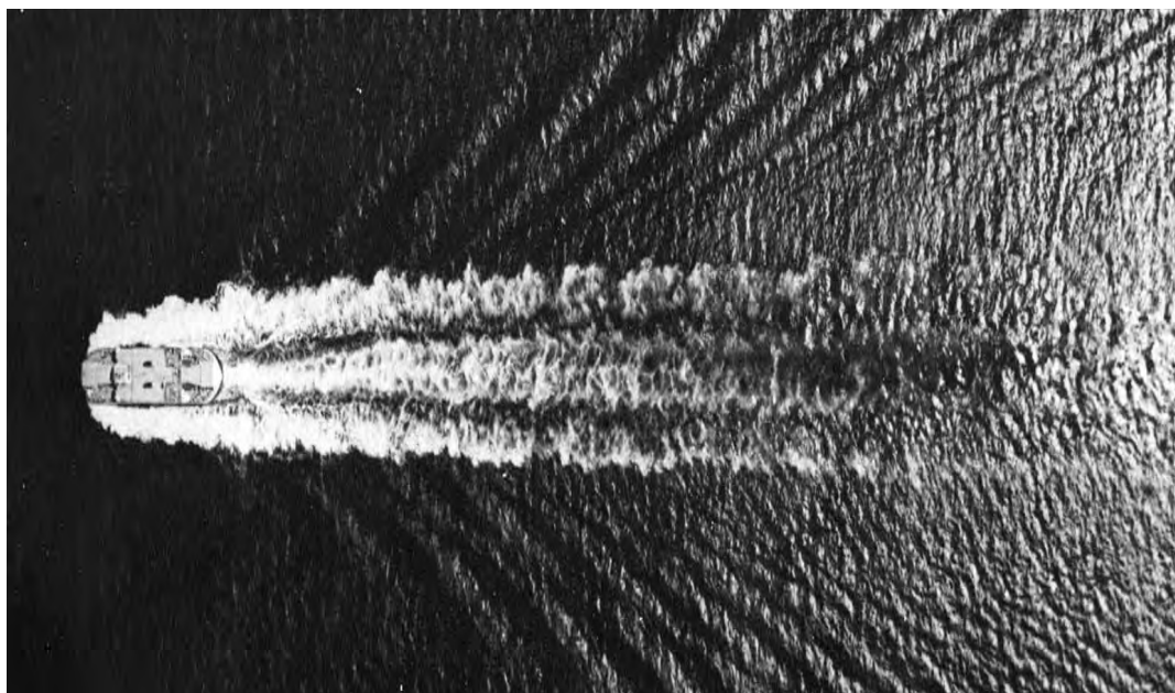
Рисунок 1 – Две вихревые системы: идущее от носа ожерелье вихрей и вихревой попутный поток, а также типичная волновая система
