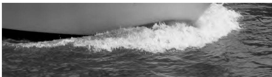
Рисунок 6 – Разрушение носовых ударных волн
