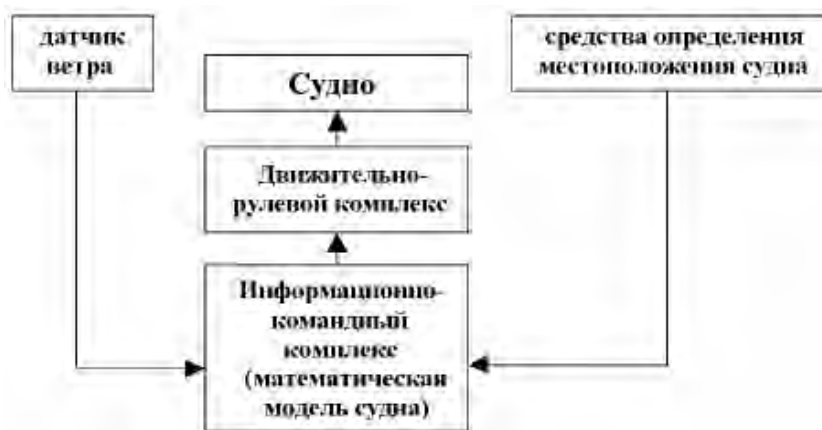
Рисунок 1 – Структура системы динамического позиционирования [2]
