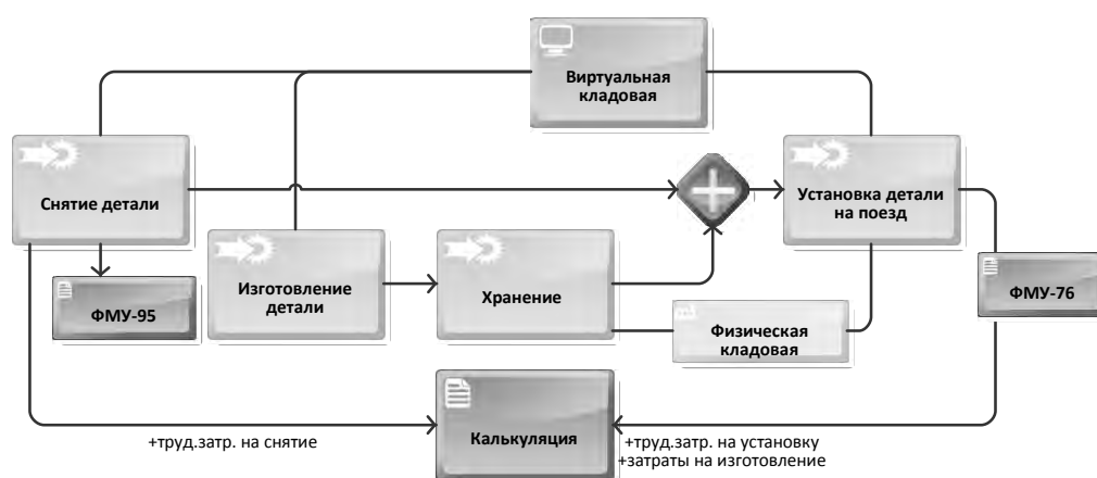
Рисунок 3 – Учет движения деталей и материалов, изготавливаемых вновь, с отображением в виртуальной кладовой
