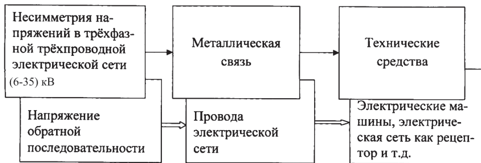
Рисунок 2 – Схема воздействия напряжений обратной последовательности в электрической сети 6-35 кВ на технические средства
