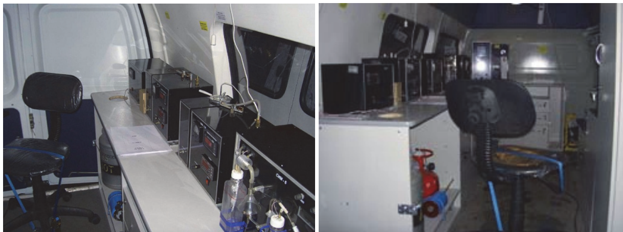
Рисунок 3 – Салон мобильной лаборатории «КЛАН-1», укомплектованный анализаторами СИМ
