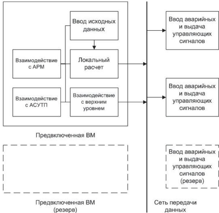
Рисунок 2 – Структура распределенной системы управления реального времени
