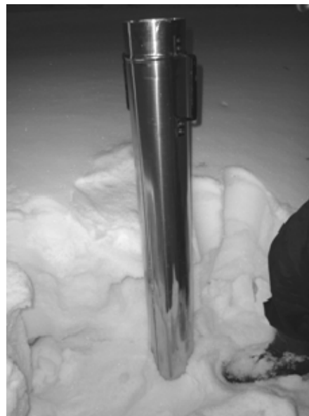
Рисунок 1 – Разрез толщи снежного покрова (слева) и пробоотборник (справа)
