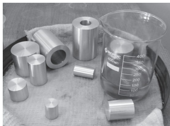
Рисунок 2 – Горизонтальные и вертикальные вставки в тигель
