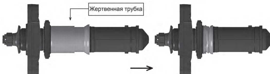
Рисунок 2 – Деформирование жертвенной трубки в короткой сцепке
