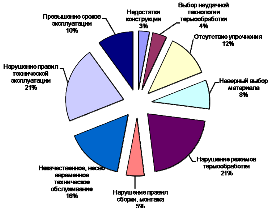
Рисунок 2 – Влияние факторов на число поломок и преждевременного выхода из строя деталей судовой техники
