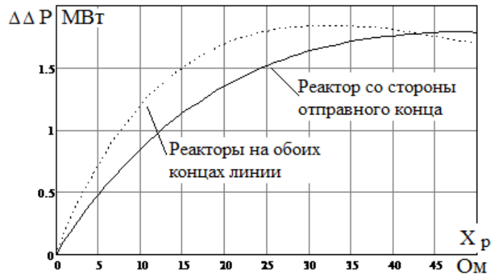
Рисунок 2 – Снижение потерь мощности в зависимости от сопротивления продольного реактора
