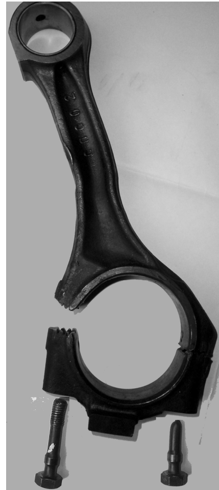
Рисунок 5 – Наружный вид шатуна второй шатунно-поршневой группы после аварии
