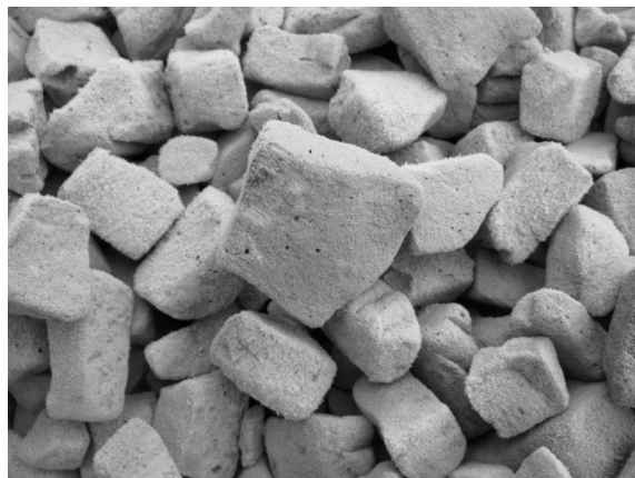
Рисунок 1 – Гранулированное пеностекло марки Nasopor Light [5]
