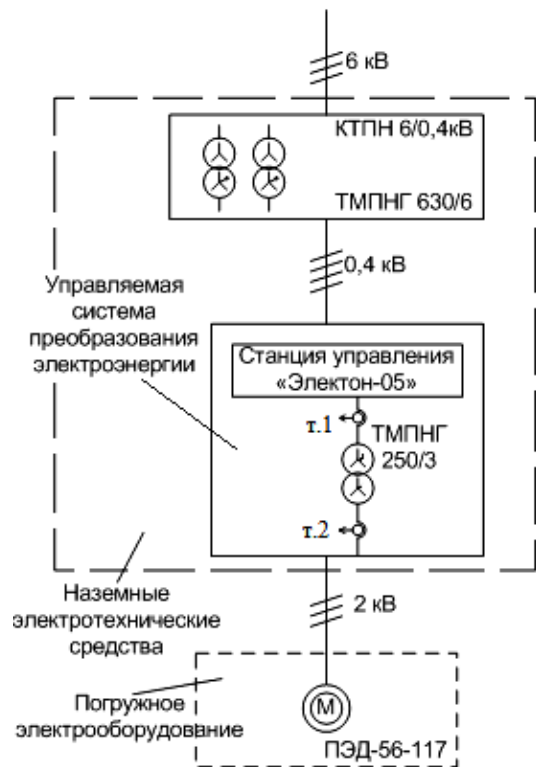
Рисунок 1 – Структурная схема электроснабжения механизированной добычи нефти из глубоких скважин: ПЭД-56-117 – маслонаполненный асинхронный погружной электродвигатель
