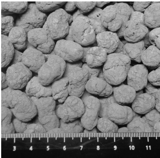
Рисунок 3 – Гранулированный теплоизоляционный материал ДиатомИК
