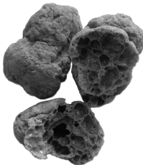
Рисунок 4 – Гранулы теплоизоляционного материала ДиатомИК на изломе
