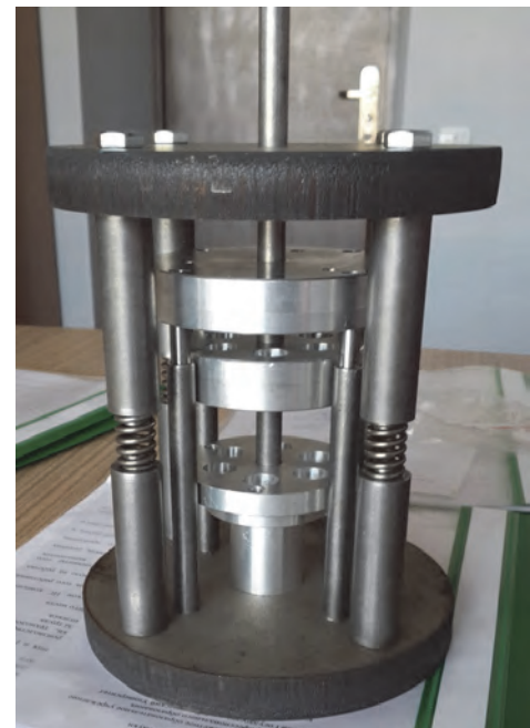
Рисунок 1 – Виброизолятор с компенсатором жесткости на основе неодимовых магнитов
