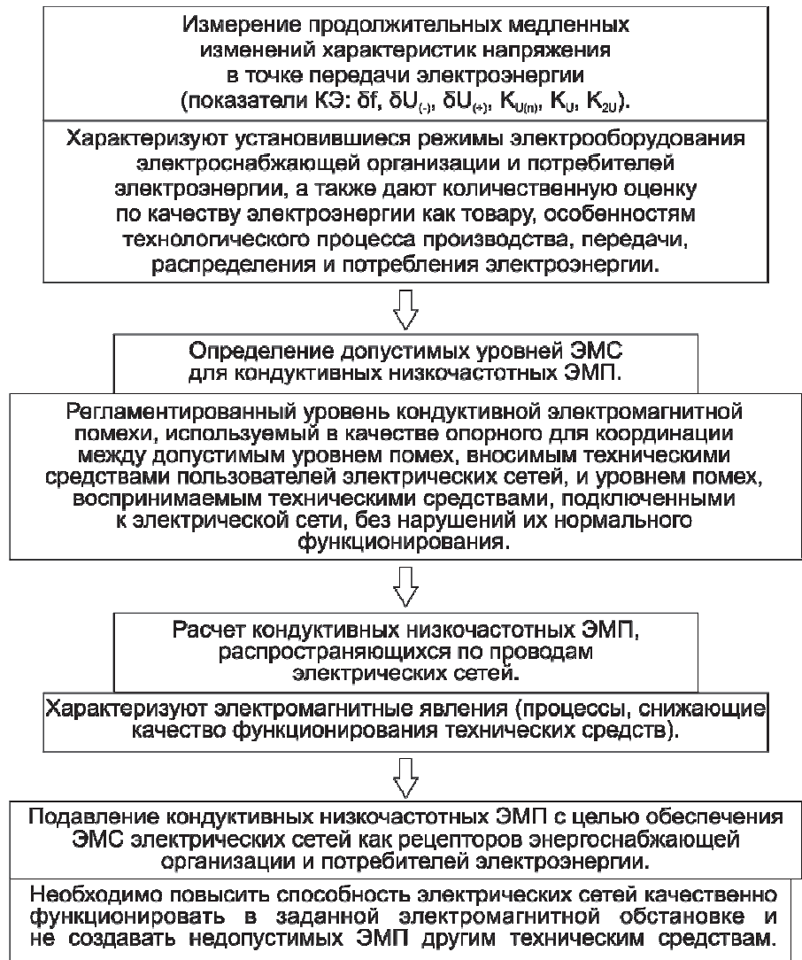
Рисунок 1 - Структура алгоритма обеспечения электромагнитной совместимости электрических сетей в точке передачи электрической энергии
