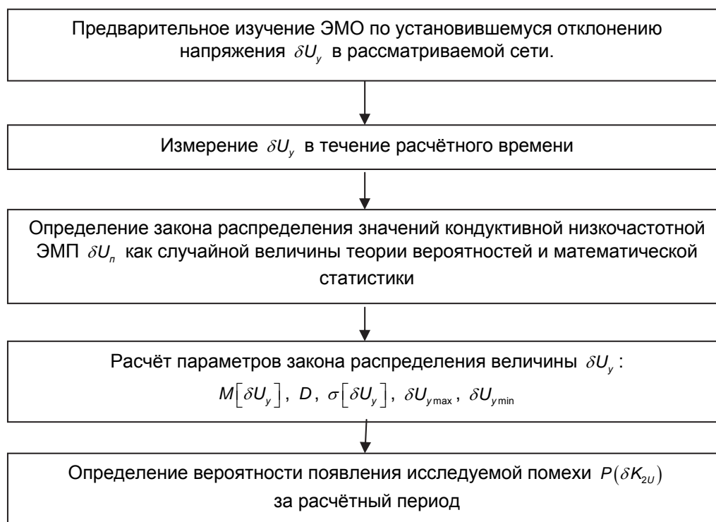
Рисунок 1 – Алгоритм определения кондуктивной низкочастотной электромагнитной помехи по медленному изменению напряжения
