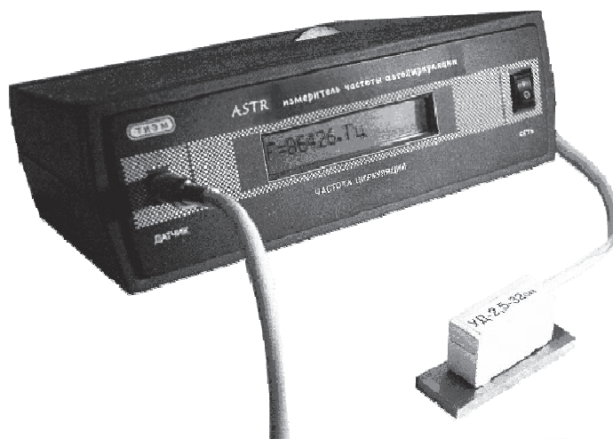
Рисунок 4 – Акустический прибор АSTR для определения действующих и остаточных напряжений
