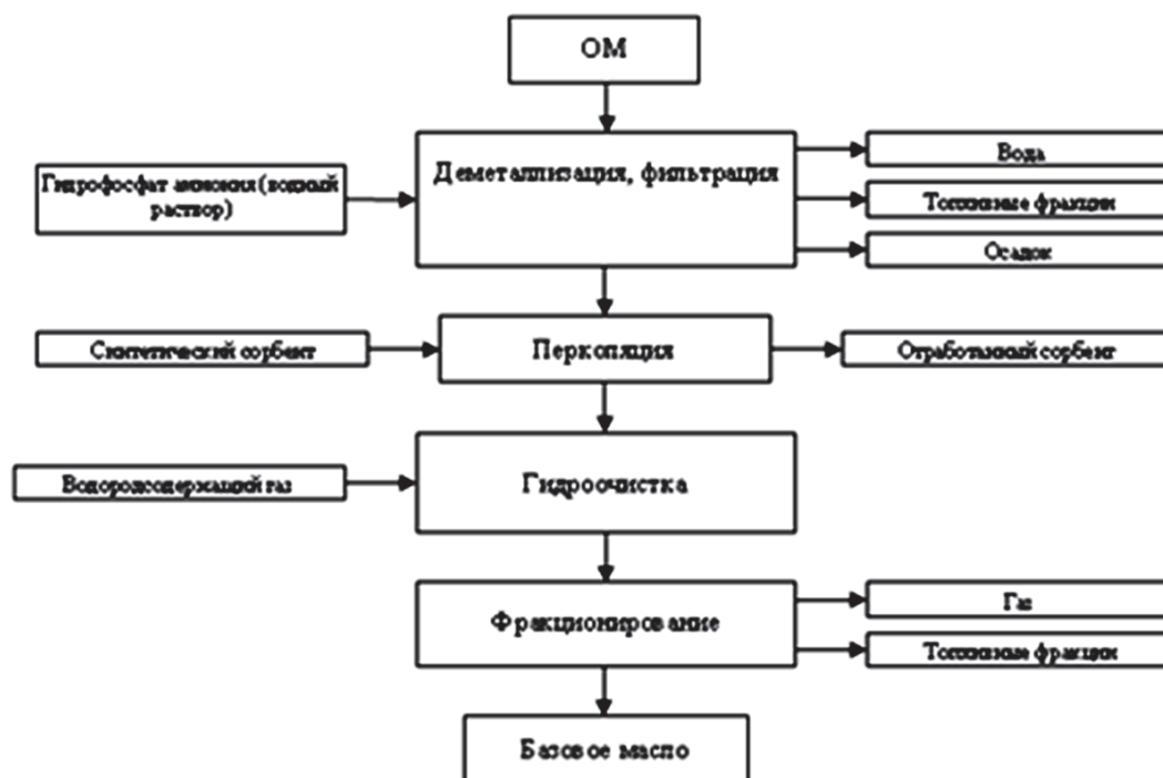
Рисунок 2 Схема процесса PROP
