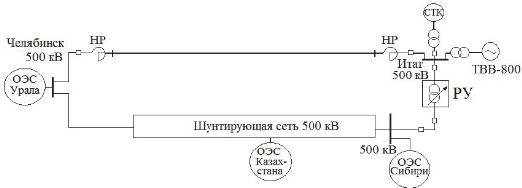
Рисунок 1 – Схема ПЭП 500 кВ Итат – Челябинск
