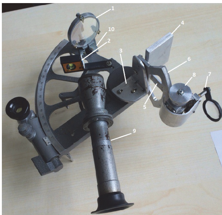
Рисунок 4 - СПБЗ М-4: 1-полупрозрачное малое зеркало(МЗ); 2-дополнительный рамный гидроуровень; 3-кронштейн; 4-поворотное большое зеркало (ПБЗ); 5-алидада ПБЗ; 6-лимб ПБЗ; 7-луна; 8-барабан алидады ПБЗ; 9-оптическая труба с основным гидроуровнем; 10-кронштейн МЗ
