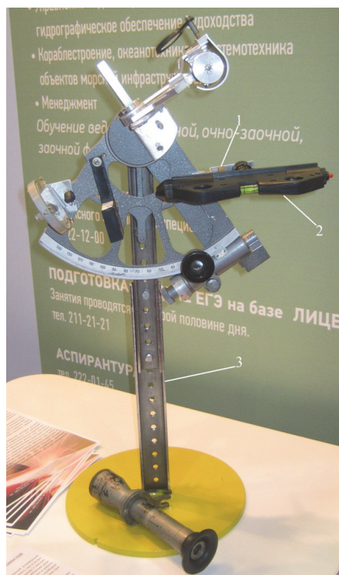
Рисунок 5 - СПБЗ с установленным лазерным указателем на испытательном стенде: 1-кронштейн; 2-лазерный указатель; 3-испытательный стенд СПБЗ
