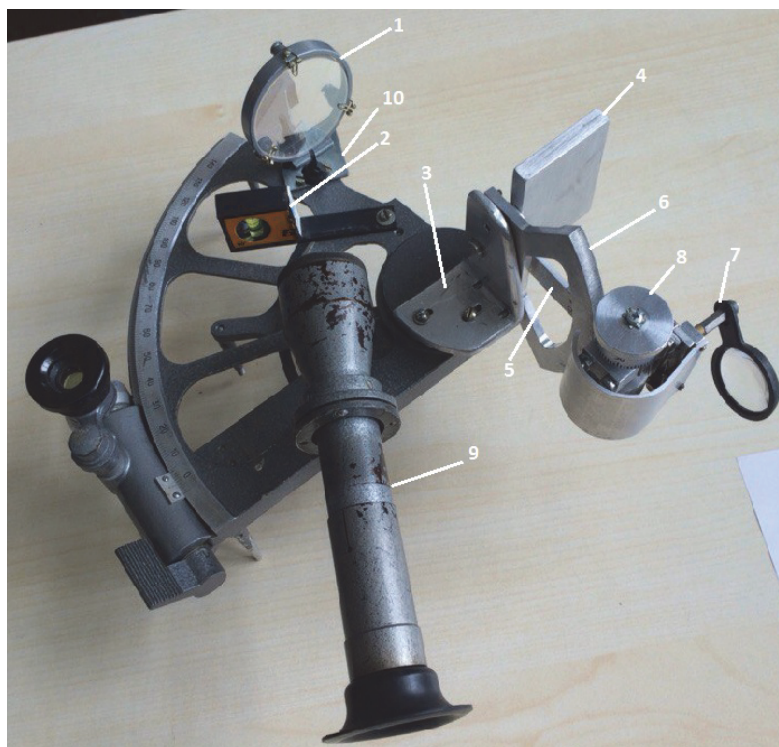
Рисунок 1 - Секстан с поворотным большим зеркалом (СПБЗ): 1-Полупрозрачное малое зеркало(МЗ); 2-дополнительный рамный гидроуровень; 3-кронштейн; 4-поворотное большое зеркало (ПБЗ); 5-алидада ПБЗ; 6-лимб ПБЗ; 7-лупа; 8-барaban алидады ПБЗ; 9-оптическая труба с основным гидроуровнем; 10-кронштейн МЗ
