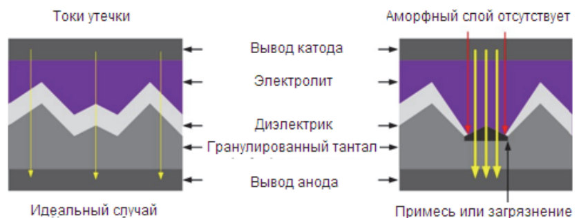
Рисунок 4 – Нарушение слоя диэлектрика при наличии загрязнений на аноде
