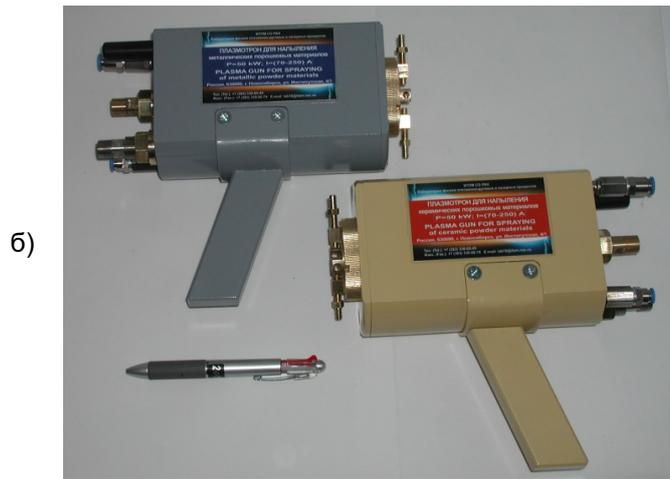
Рисунок 4 – Схема (а) и внешний вид плазмотрона «ПНК-50» (б): 1-катод; 2-пусковая секция; 3-секции межэлектродной вставки; 4-переходная секция; 5-анод; 6-узел кольцевого ввода порошка с газодинамической фокусировкой; 7-плазмообразующий газ; 8-защитный газ; 9-частицы порошка с транспортирующим газом; 10-фокусирующий газ
