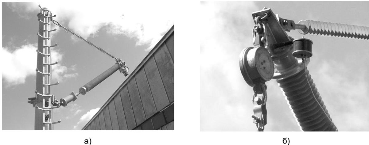
*Рисунок 1 – Подготовленная к испытаниям траверса (а) и закрепленный измерительный пост (б)*
