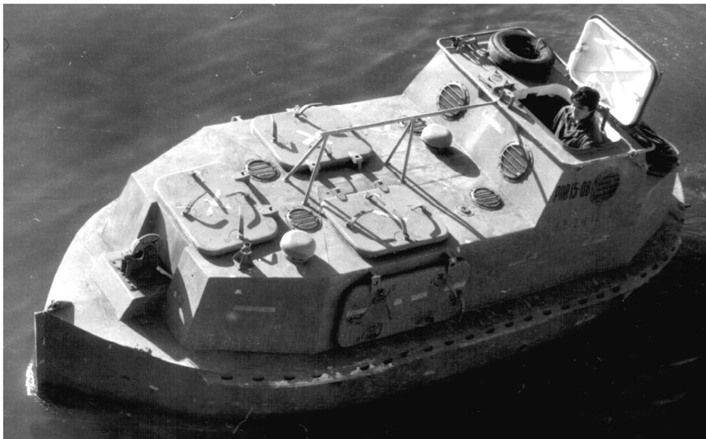
*Рисунок 1 – Морская шлюпка со стационарной гребной электрической установкой на ходовых испытаниях в Амурском заливе*
