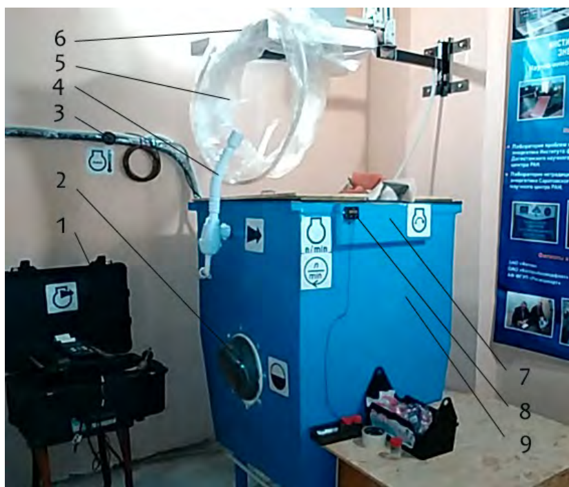
Рисунок 1 – Общий вид малого опытового бассейна: 1-газоанализатор Testo 350 MARITIME; 2-прозрачное стекло для наблюдения за барботажем; 3-термометр для измерения температуры воды; 4-устройство для отбора отработавших газов с краном для дренажа воды; 5-защитный кожух для отвода отработавших газов в вентиляцию; 6-вытяжная вентиляция с подсветкой и тремя режимами работы вентилятора; 7-транцевая доска толщиной 40 мм для крепления подвешенного мотора; 8-датчик частоты вращения двигателя; 9-бак объемом 750 л (высота бака 1100 мм)
