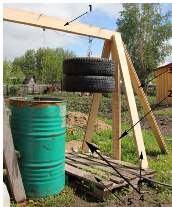
Рисунок 2 – Испытательный стенд: 1-рама с нагрузочным устройством; 2-шкала перемещений; 3, 4-стойки рамы; 5-ёмкость с водой
