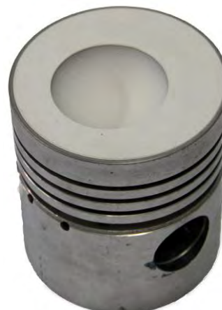
Рисунок 2 – Общий вид опытного поршня дизеля Ч10,5/12 с теплоизоляционным покрытием стенки камеры сгорания
