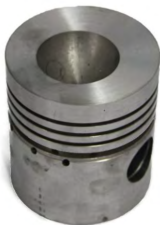
Рисунок 1 – Общий вид штатного алюминиевого поршня дизеля Ч10,5/12
