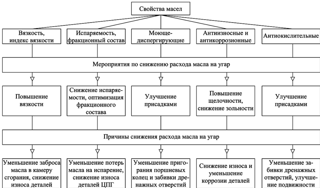
Рисунок 1 – Механизмы влияния масел на угар в зависимости от их физико-химических свойств
