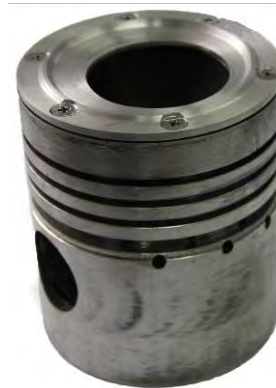
Рисунок 3 – Общий вид опытного поршня с профилированной сменной стальной пластиной
