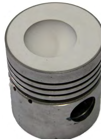
Рисунок 2 – Общий вид опытного поршня с теплоизоляционным покрытием стенок камеры сгорания
