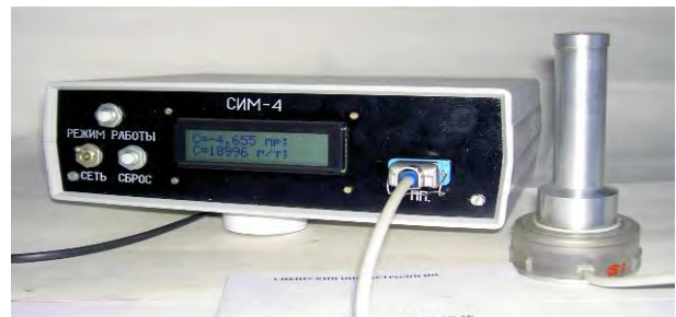
Рисунок 2 – Экспресс-анализатор содержания воды в нефтепродуктах СИМ-4
