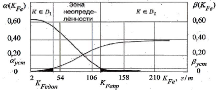
Рисунок 1 – Распределение вероятностей ошибок диагноза по концентрации железа для различных состояний дизеля Г70-5: α -ошибка «ложной тревоги»; β -ошибка «пропуска дефекта»
