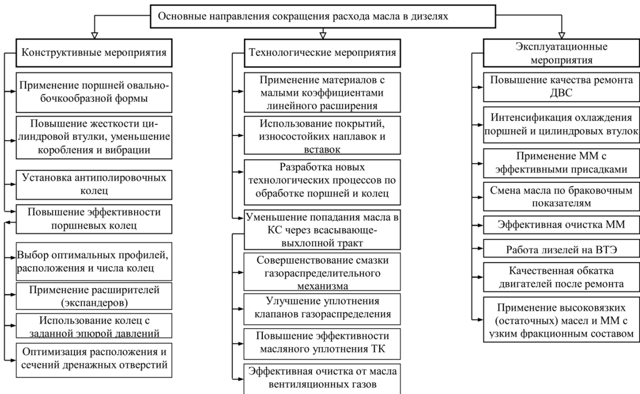
Рисунок 2 – Пути снижения расхода моторного масла в ДВС
