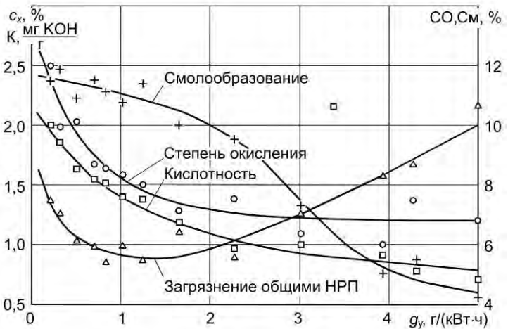
Рисунок 2 – Старение масла в дизеле 2Ч 10,5/13 в зависимости от его угара
