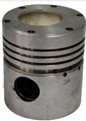
Рисунок 2 – Общий вид опытного поршня с плоской сменной стальной пластиной
