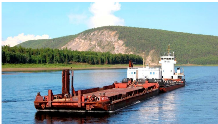
Рисунок 4 – Транспортное судно проекта СК-2000К с баржей-приставкой
