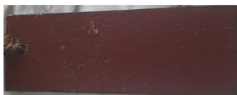
Рисунок 5 – Образец 4 после 20 часов работы установки с добавлением песка
