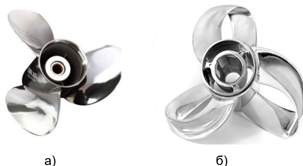
Рисунок 1 – Гребные винты: а) – с лопастями традиционной формы; б) – с петлевыми лопастями
