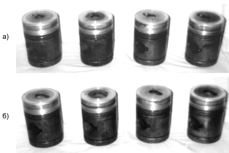
Рисунок 3 – Восстановленные алюминиевые поршни дизеля 4Ч10,5/13
