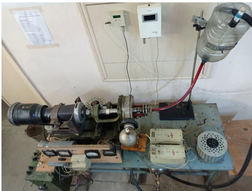
Рисунок 1 – Экспериментальная установка для обработки судового маловязкого топлива с использованием кавитации и высоковольтного электрического заряда
