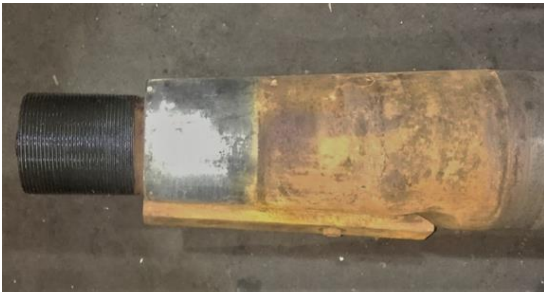
Рисунок 2 – Посадка ступицы винта по малому диаметру конуса
