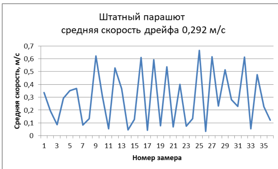
Рисунок 15 – Трековая скорость дрейфа плота, оснащённого штатным средством снижения дрейфа - плавучим якорем в виде парашюта. Максимальная скорость 0,667 м/с; минимальная 0,035 м/с; средняя 0,292 м/с
