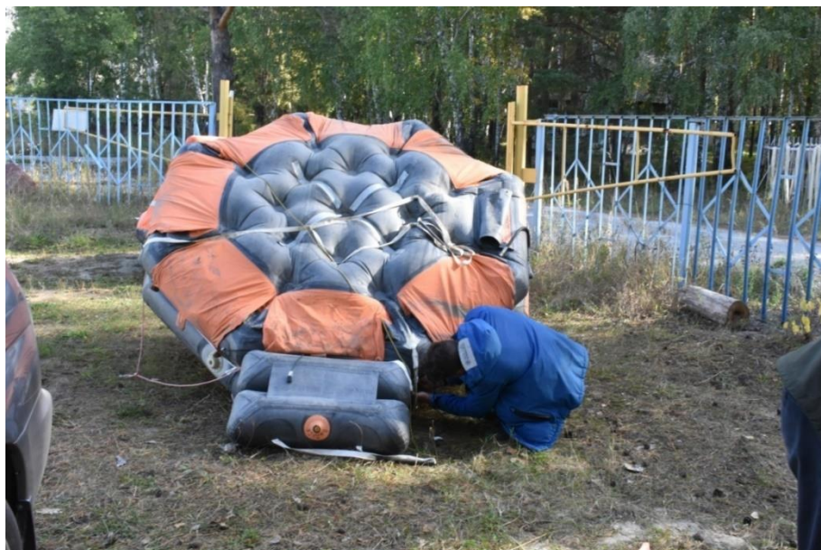
Рисунок 5 – Подвязывание балластных карманов к нижнему корпусу плота
