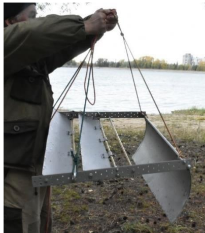
Рисунок 13 – Крыльевой ГДЯ с продавленным через ограничитель большим крылом. Обнаружено по завершении эксперимента
