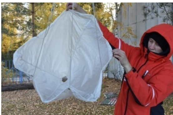
а) штатный плавучий якорь – парашют
