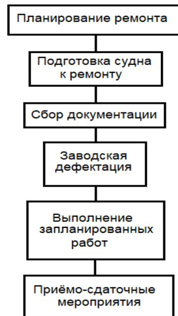
Рисунок 8 – Схема организации ремонта судна
