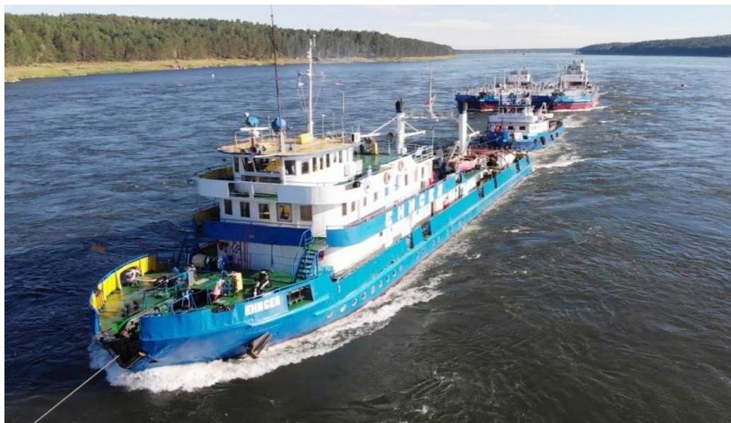
Рисунок 2 – Схема проводки флота судно Туер-буксир «Енисей»
