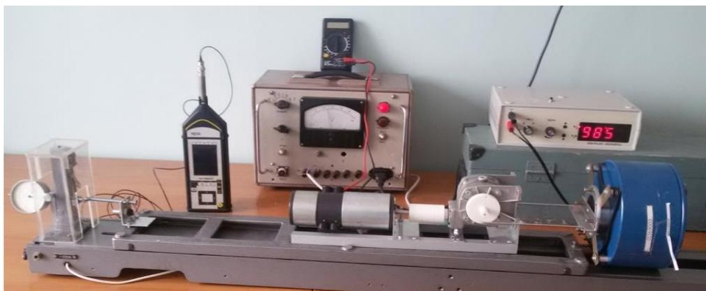
Рисунок 1 – Исследования вибрации с использованием прибора ОКТАВА-110А-ЭКО
