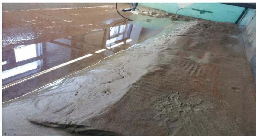
Рисунок 5 – Малая размываемая гидравлическая модель
