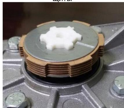
Рисунок 2 – Многодисковая муфта со снятой полумуфтой
