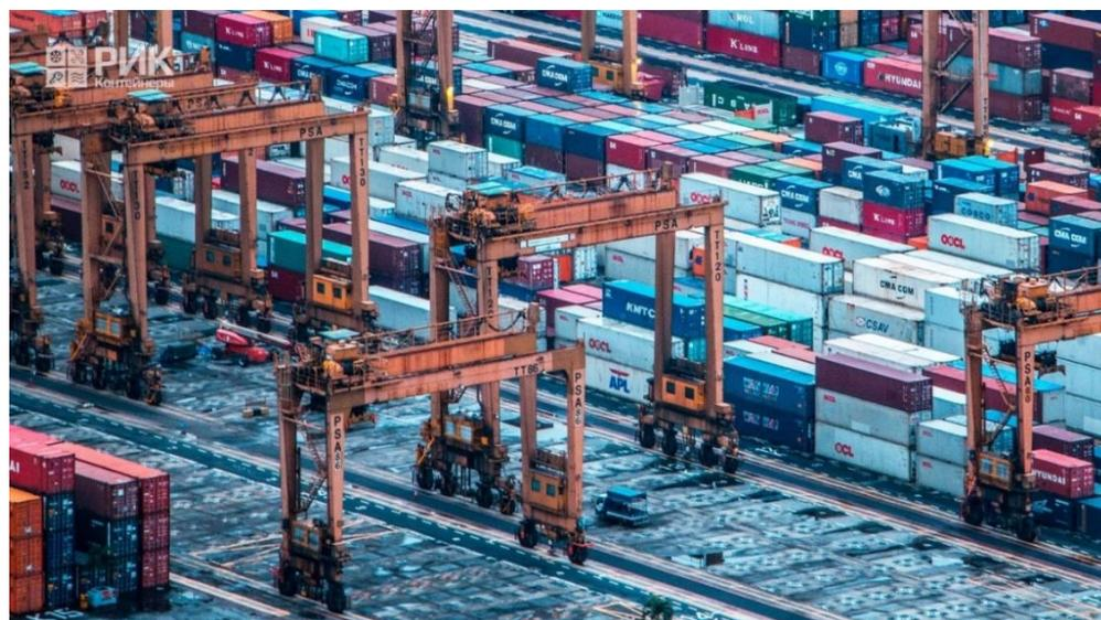
Рисунок 4 – Козловые краны на пневмоходу
