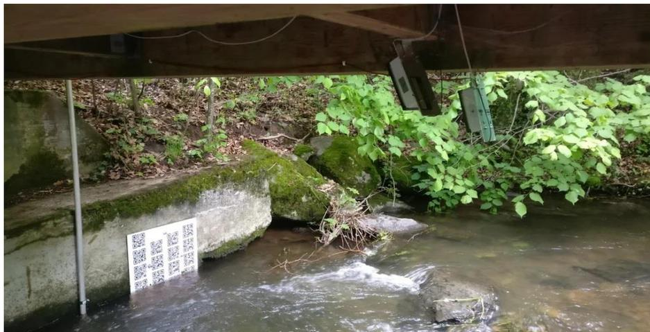
Рисунок 3 – Регистратор уровня воды со встроенным QR-кодом
