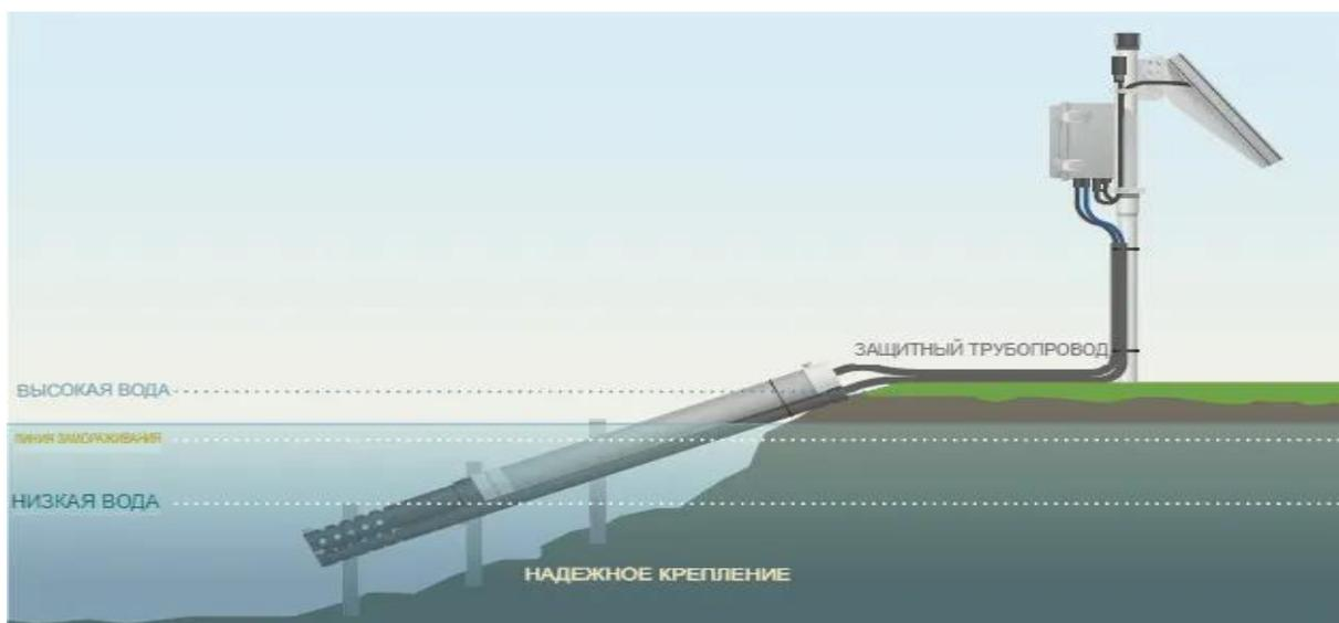
Рисунок 5 – Система мониторинга уровней воды на основе Интернета вещей
