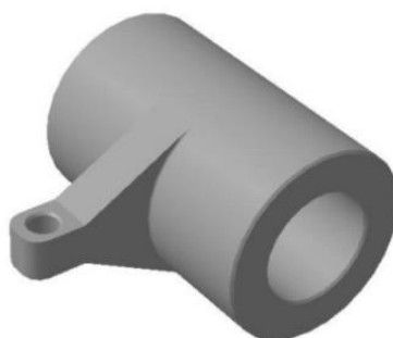
Рисунок 2 – Неподвижная полумуфта компенсатора веса с рычагом
