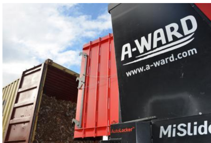
Рисунок 5 – Загрузка металла системой MiSlide™ в крупнотоннажный контейнер
