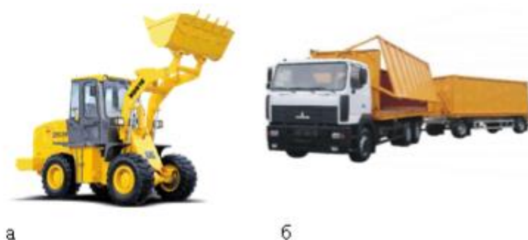
Рисунок 4 – Виды перегрузочных и перевозочных средств для перевозки отходов лесной промышленности: а – ковшовый погрузчик; б – щеповоз
