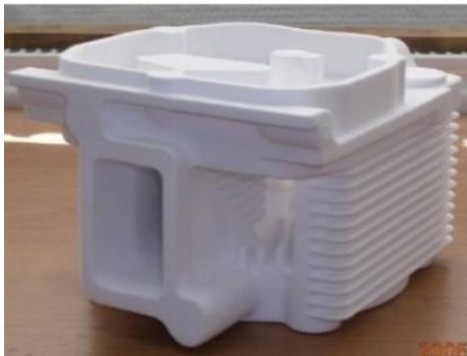
Рисунок 4 – Полистирольная модель головки цилиндра ДВС
