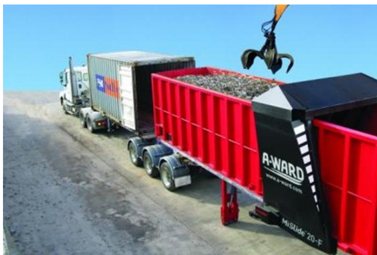
Рисунок 4 – Загрузка металла системой MiSlide™ в крупнотоннажный контейнер
