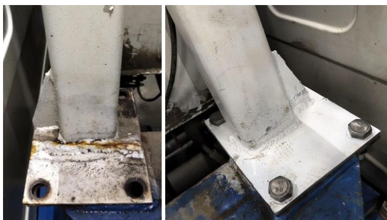
Рисунок 3 – Ремонт основания стойки транспортного положения стрелы - трещина по ремонтному сварному шву: а) до ремонта б) после ремонта
