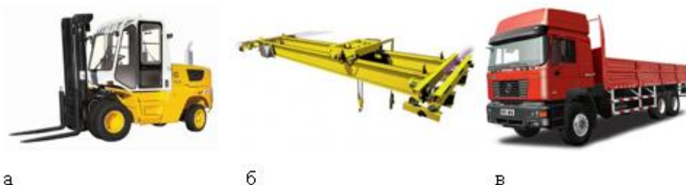
Рисунок 3 – Технические средства перегрузки и перевозки пиломатериалов: а – автопогрузчик; б – мостовой кран; в – бортовой грузовой автомобиль
