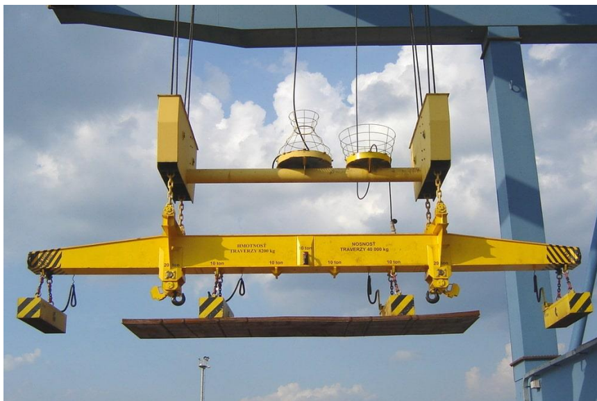
Рисунок 1 – Крановая перегрузка металло-грузов магнитными ГЗУ
