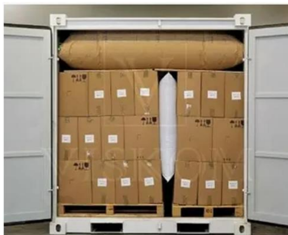
Рисунок 9 – Крепление ящиков в контейнере с помощью надувных пневмо-оболочек
