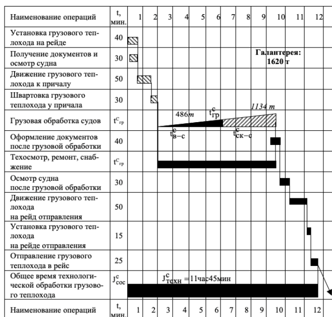
Рисунок 2 – Примерный типовой технологический цикл полной обработки самоходного сухогрузного теплохода
