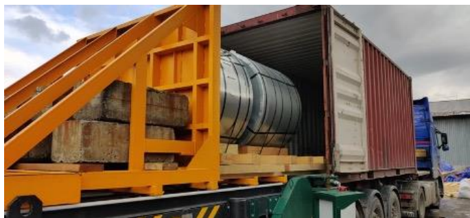
Рисунок 8 – Погрузка металла с помощью перегрузочного стола
