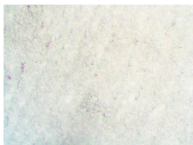
Однослойное графеновое покрытие полимерной газопроницаемой мембраны
