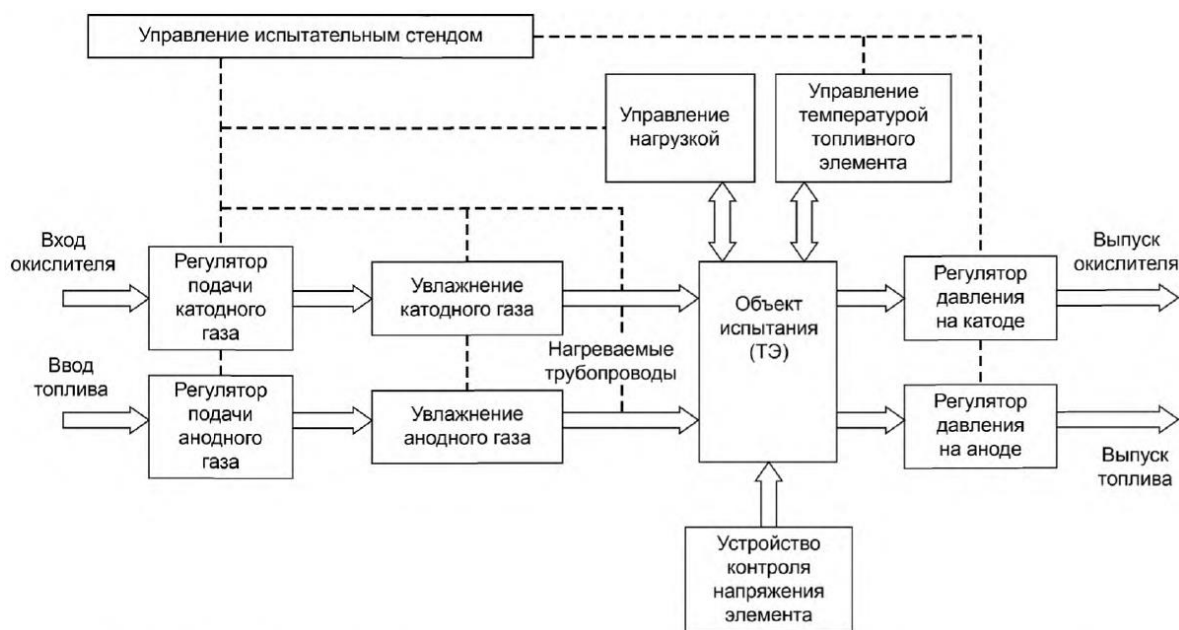
Рисунок 2 – Принципиальная схема стенда для испытаний топливного элемента
