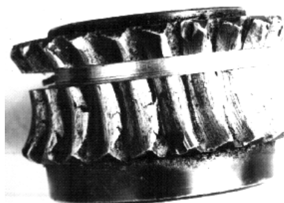
Рисунок 13 – Общий вид изломанных зубьев шестерни из стали 20, не прошедший термической обработки
