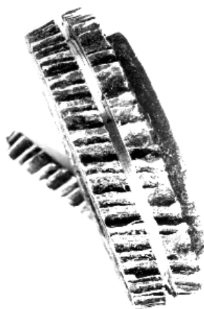
Рисунок 7 – Излом зубьев шестерни токарного станка 1К62
