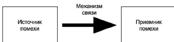
Рисунок 2 – Схема электромагнитного влияния
