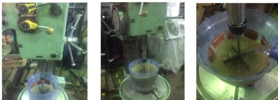
Рисунок 1 – Экспериментальная установка проверки ЛКП на истирание
