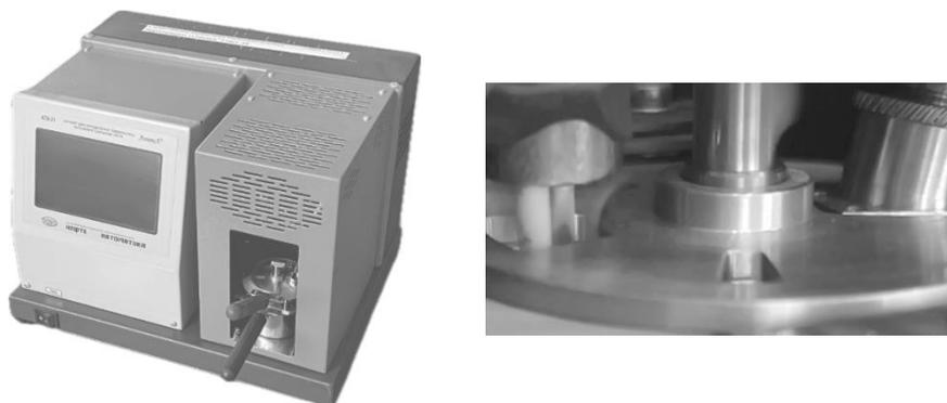
Рисунок 3 – Аппарат для определения температуры вспышки нефтепродуктов и момент вспышки паров опытного образца
