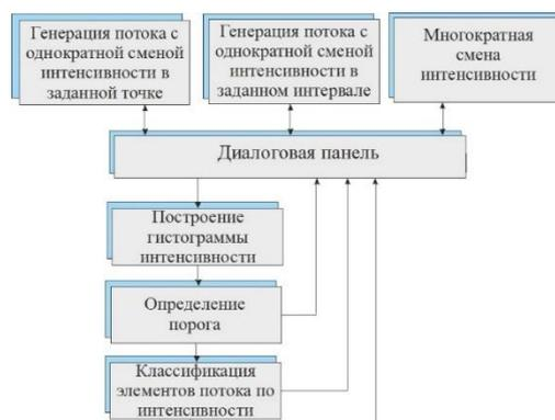
Рисунок 1 – Структурная схема программы для моделирования потоков событий
