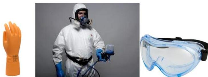
Рисунок 3 – Защитные средства при окрасочном производстве
